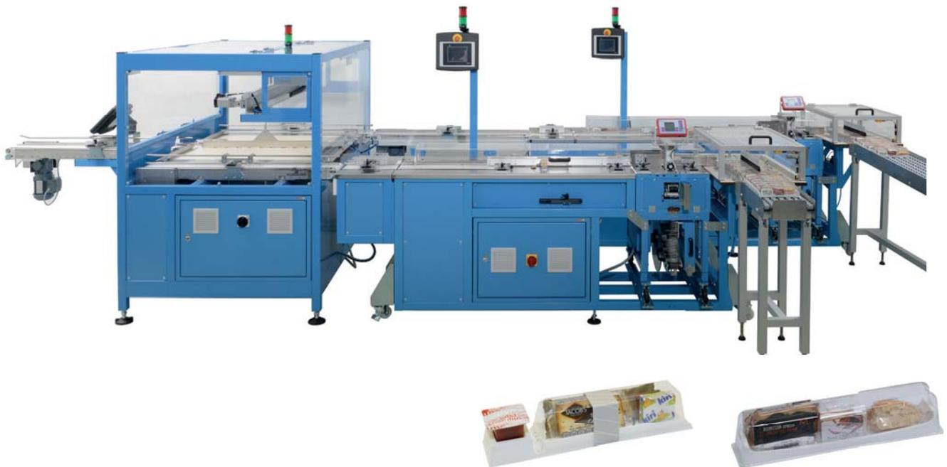
Snackboxen werden direkt ab der Produktionsanlage übernommen und in der US-2000 DPIC-CB auf zwei Produktströme aufgeteilt. Nach dem Transport mittels Stiftförderer werden die Snackboxen sanft banderoliert und auf die Auslauf-Rollenbänder gestossen. Dank der beiden Produktströme und den optimal auf die Produktdimensionen abgestimmten Rundbögen der Banderoliermaschinen erreicht die Anlage bis zu 100 Banderolierungen/Min.
