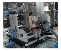
Hochleistungs-Anleger mit Servomotor. Spezialausführung für Papier- und Polymer-Banknoten.
