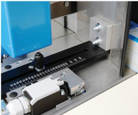
Die einfache Formatumstellung erfolgt manuell mittels angebrachtem Massstab.
