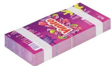
Automatisches Bänderolieren von Etikettenstapeln. Durch die einfache Bedienung via Touch-Screen wählt man die Anzahl Stapel und Bänderolierungen. Nach der 2-Handauslösung erfolgt der Start und die Etikettenstapel werden eingeschoben und banderoliert.
