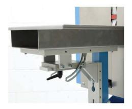
Durch den leicht verstellbaren Schrägtisch wird die genaue Positionierung des Produktes erleichtert. Je nach Produkt sind unterschiedliche Schrägtische lieferbar.
