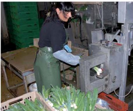
Auch in feuchter Umgebung arbeitet die US-2000 TTP-V-R verlässlich. Die rostfreie Maschine garantiert unproblematisches Arbeiten mit Lebensmitteln wie hier im Bild bei den Frühlingszwiebeln. Die Steuerung und der Abroller sind oben montiert und ermöglichen dadurch eine problemlose Bodenreinigung mit Wasser. Die zusätzliche Kanalabdeckung verhindert Schmutz im Bandkanal.
